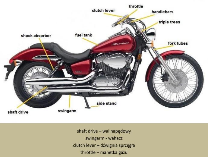
clutch lever – dźwignia sprzęgła throttle – manetka gazu handlebars - kierownica triple trees – półki widelca fork tubes – rury widelca (lagi) side stand – podpórka boczna
